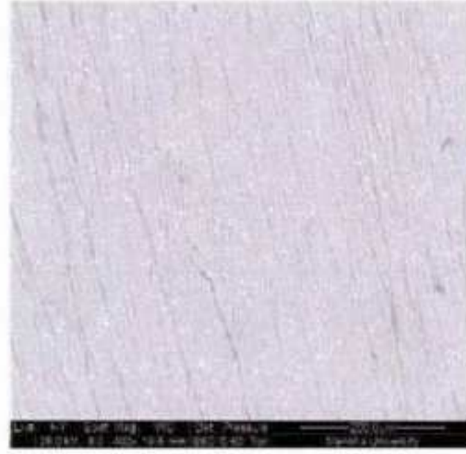
الشكل (3) صورة مركز عينة Molloplast-B ® مأخوذة بالمجهر الإلكتروني الماسح تكبير 400
