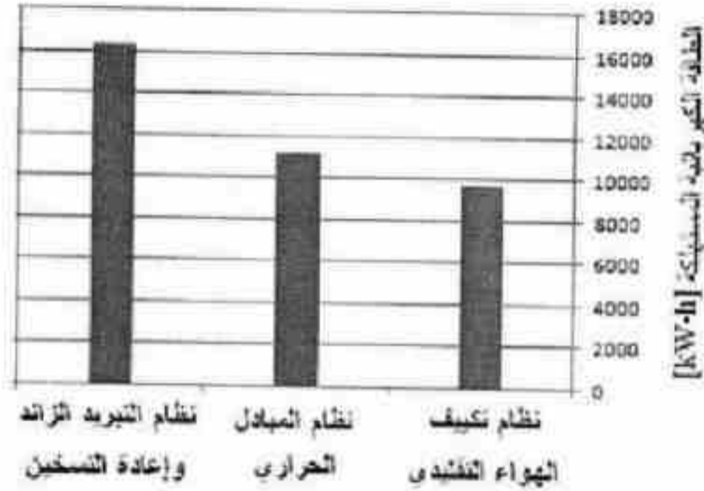
الشكل (7) متوسط استهلاك الطاقة الكهربائية لكل من نظام تكييف الهواء التقليدي ونظام المبادل الحراري ونظام التبريد الزائد وإعادة التسخين
