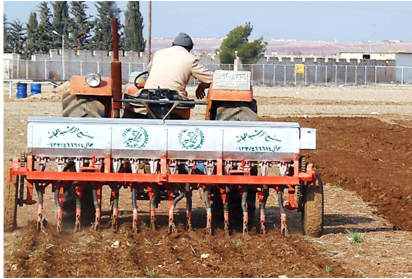
الشكل (2): آلة الزراعة الحافظة المستخدمة في التجربة.
