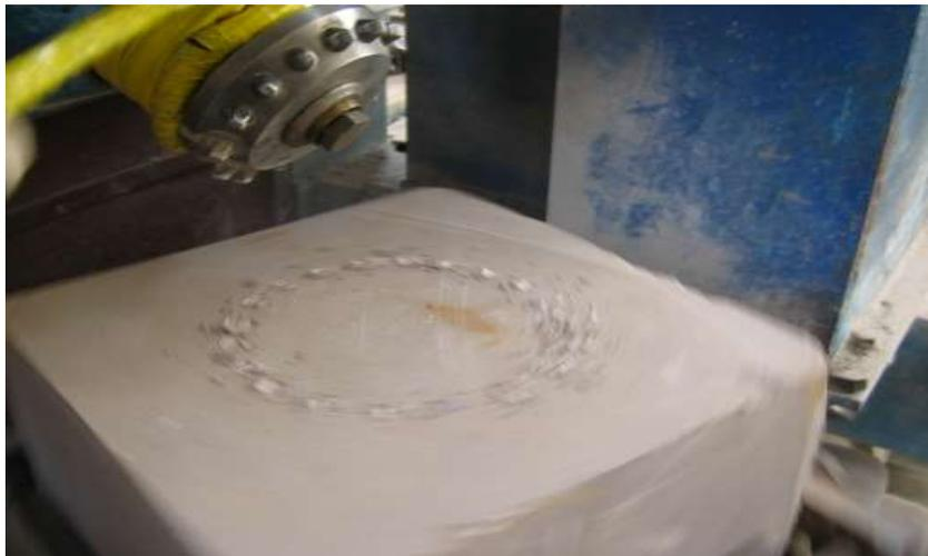
الشكل (1) جهاز محاكاة حفر الصخور مخبرياً
