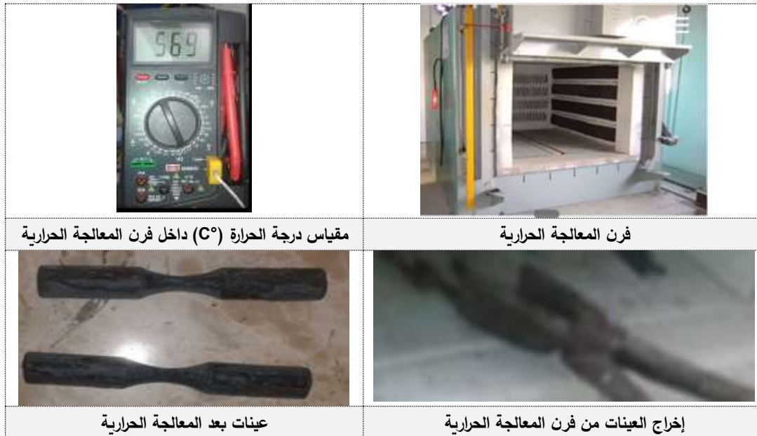
الشكل (5) الفرن المستخدم لإجراء المعالجة الحرارية على العينات، ومقياس درجة الحرارة (C°) داخل فرن المعالجة الحرارية.
