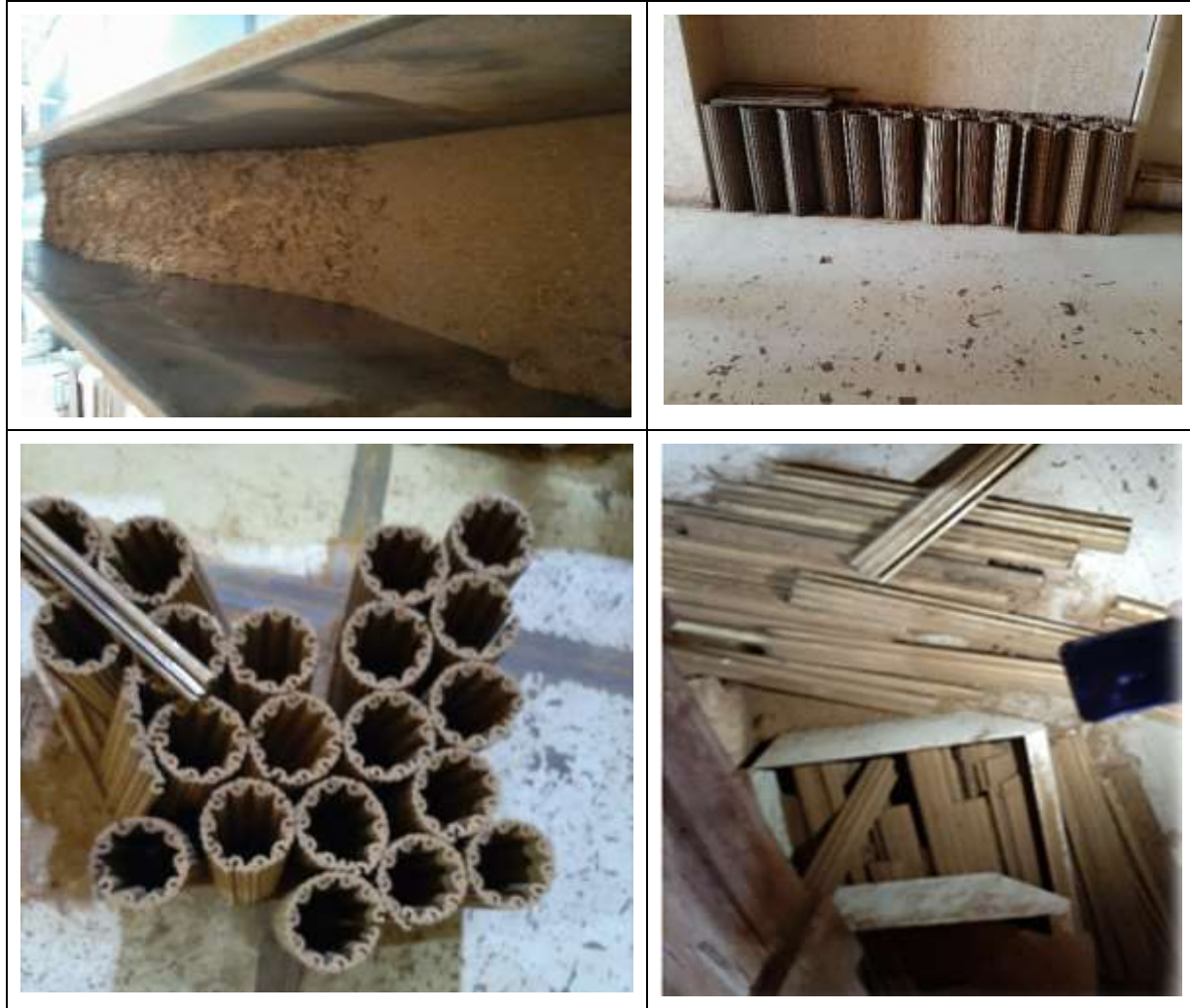
الشكل (2) لوحات الوصل المنسقة ومادة التنغ المهذورة بعد انهيار السلاسل الناقلة (الملاحظات المرئية في موقع العمل).
