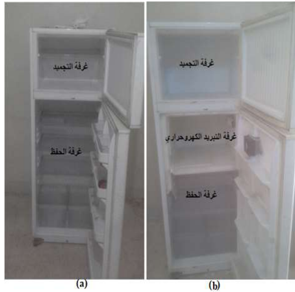
الشكل (1) الغرف التبريدية للمبرّد المنزلي الهجين المدروس والمبرّد الانضغاطي الاساسي.
