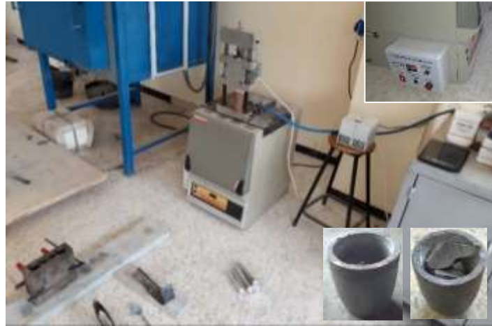
الشكل (8) آلة السباكة بالمزج التي تم تصنيعها مع باقي الملحقات (SCT)
