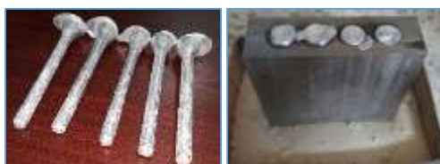
الشكل (9) القالب والعينات بعد الصب
