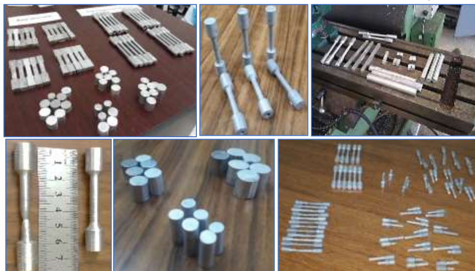
والشكل (13) يوضح تجهيز عينات الاختبارات الميكانيكية والفحص المجهر:
